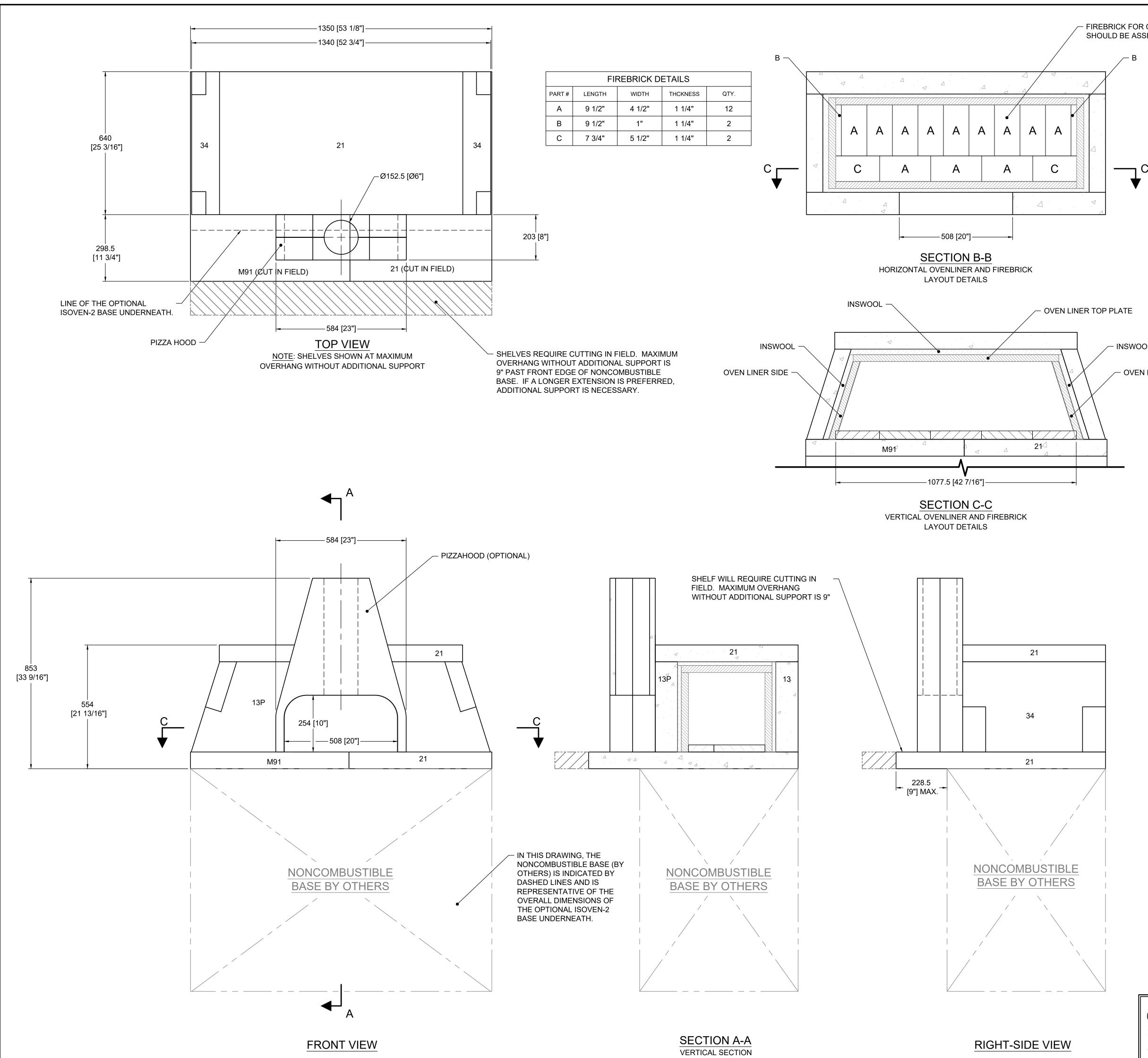
FIREBRICK FOR OVEN ARE PRECUT, AND SHOULD BE ASSEMBLED AS SHOWN
