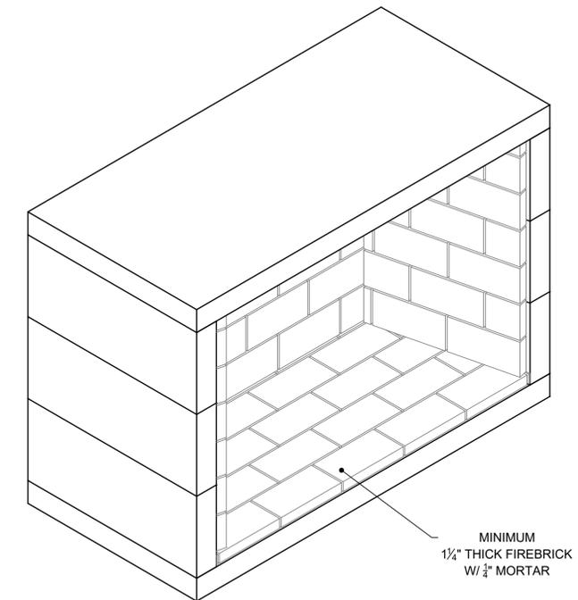
MINIMUM 1/4" THICK FIREBRICK W/ 1/4" MORTAR
